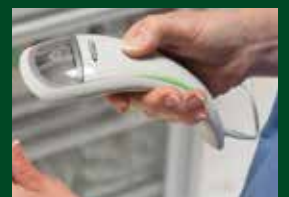
Der Barcodescanner erfasst Chargennummern und Verfallsdaten
